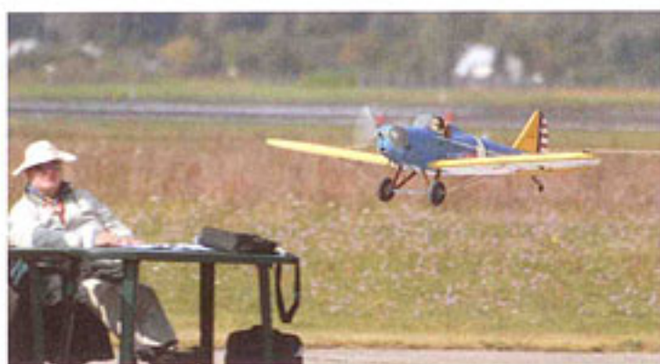
Ładnie prezentujący się model samolotu Fly Baby, latający na uwięzi w klasie F4B. Skala 1:5,26. Napęd – silnik Os Max FS 52 o pojemności 8 cm 3 . Wykonawcą makiety jest Radosław Oleksy z Aeroklubu Ostrowskiego / Zdjęcie: Ewa Tyburczy
