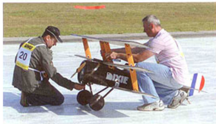
Ładnie prezentujący się model samolotu Fly Baby, latający na uwięzi w klasie F4B. Skala 1:5,26. Napęd – silnik Os Max FS 52 o pojemności 8 cm 3 . Wykonawcą makiety jest Radosław Oleksy z Aeroklubu Ostrowskiego / Zdjęcie: Ewa Tyburczy
